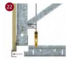
■ VERTICAL SCREW-FIX SYSTEM DETAIL
