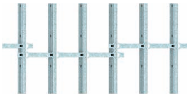
图12: FAST-FIX NOGGING® 快速安装型横撑加固钢骨安装
