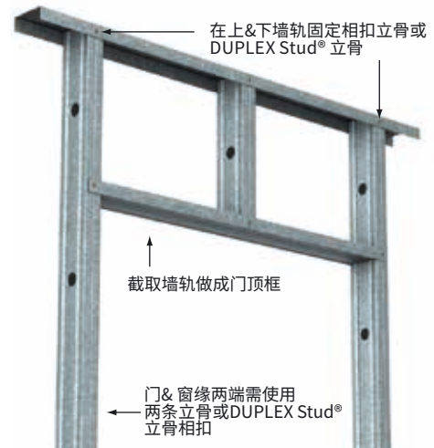
细节图A: 门/窗顶框细节
